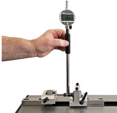
Einstellung von 2-Punkt-Bohrungsmessgeräten
