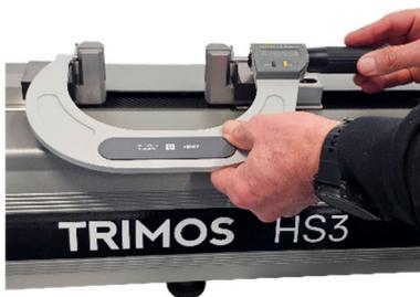
Überprüfung von Bügelmessschrauben
