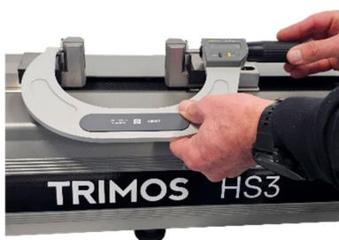
Vérification de micromètres
