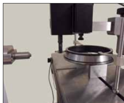
Mesure extérieure automatique d'une bague conique
