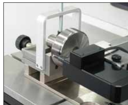
Etalonnage de tampons à filetage conique (TA-MS-381/TEL75)
