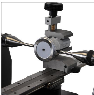
Contrôle de tampon lisses (jusqu'à \varnothing 100mm, longueur 280mm) (TULM6/L0.5, LABC15)
