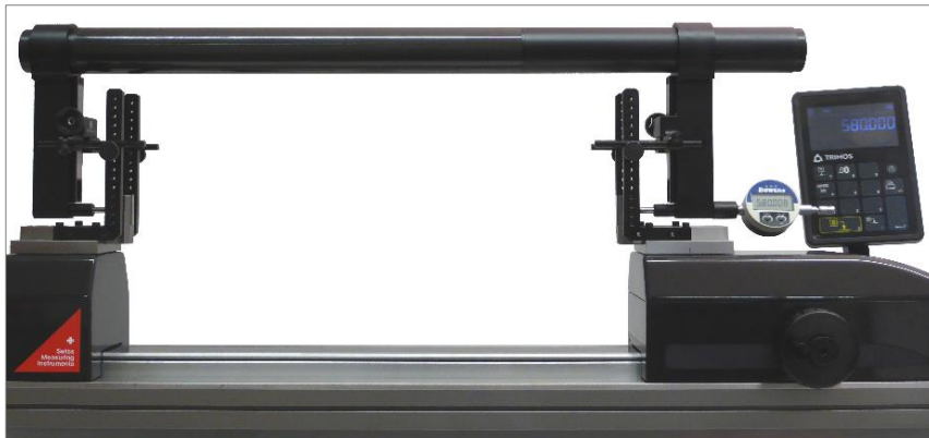
Etalonnage d'une jauge de grande dimension
